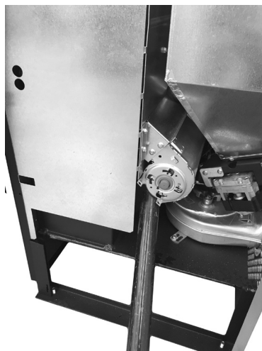
Fig. 45 - Room fan cleaning
